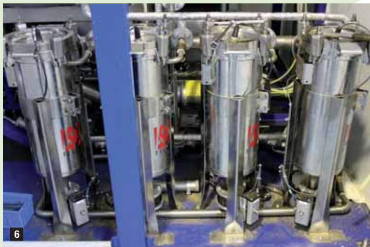
6 The four-filters array for the burr. La batteria di 4 filtri per il truciolo metallico.
