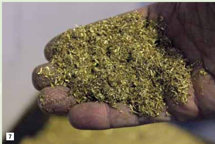
7 The burr extracted from the filter is completely dry. Il truciolo estratto dai filtri si presenta completamente asciutto.
