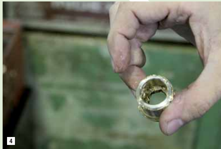
4 A component after the turning, completely covered by the production oils. Un pezzo dopo la tornitura, completamente coperto dagli oli di lavorazione.
